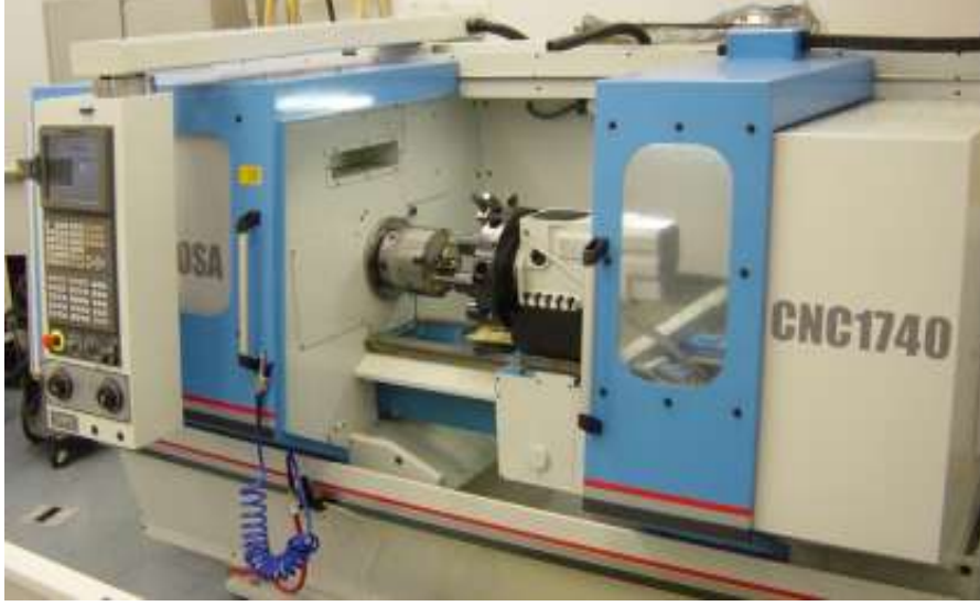
Resim 1.1: CNC torna tezgâhı
