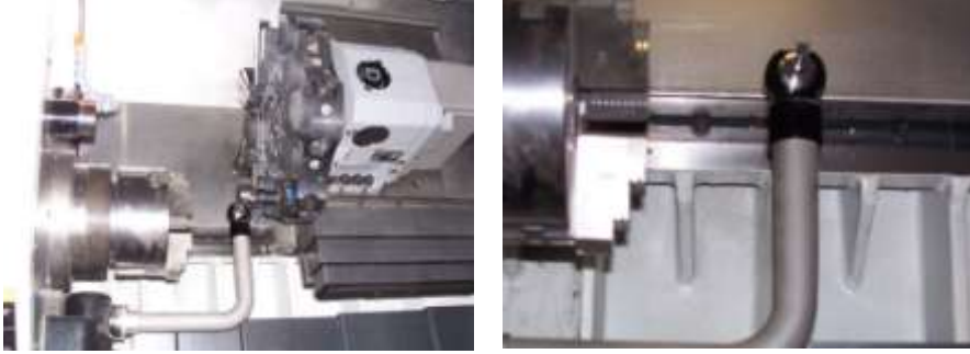
Resim 5.1: Kesici kalibrasyonunda kullanılan ölçme kolu
