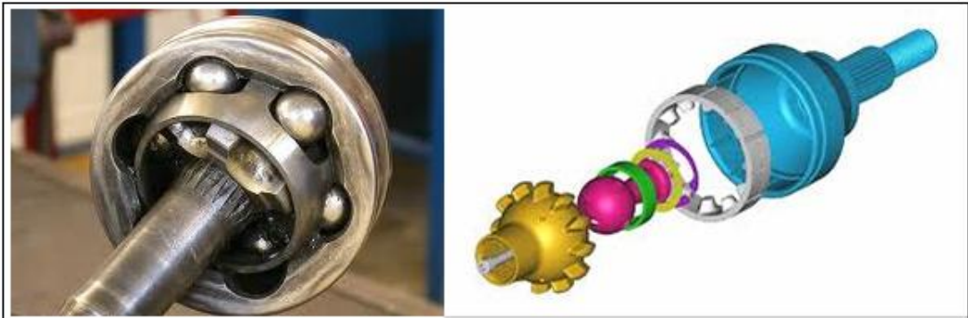
Şekil 1.4: Bilye-masuralı tip üniversal mafsal
