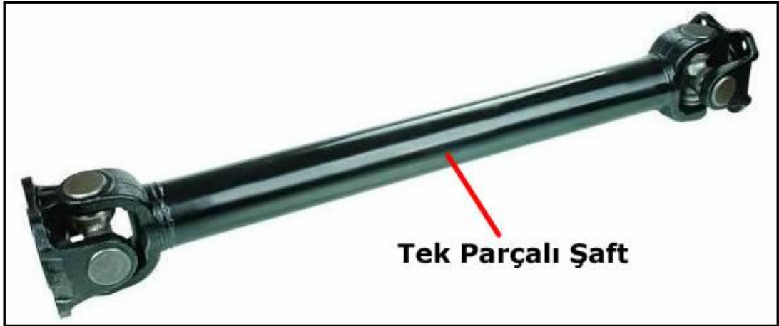
Resim 1.2: Tek parçalı şaft
