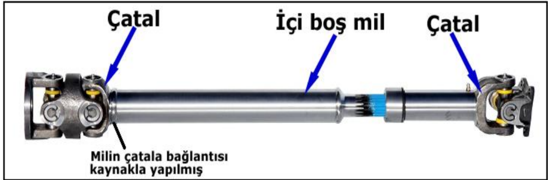
Resim 1.1: Şaftın genel yapısı
