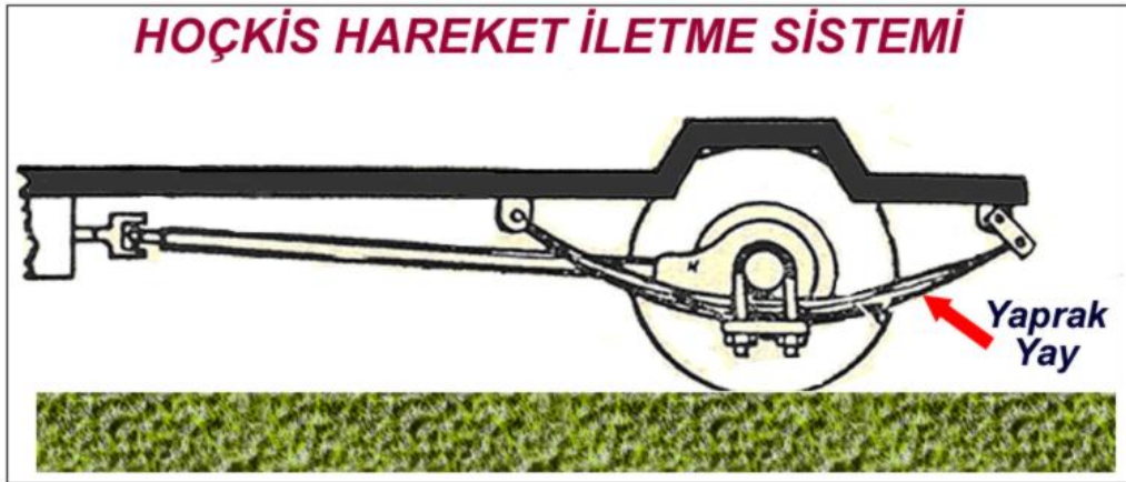
Şekil 1.9: Hoçkis hareket iletim sistemi
