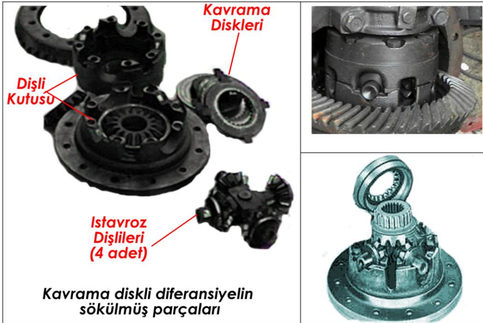
Şekil 2.7: Kavrama diskli diferansiyel
