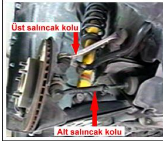
Resim 3.4: Salıncak kollarının araç üzerindeki yeri
