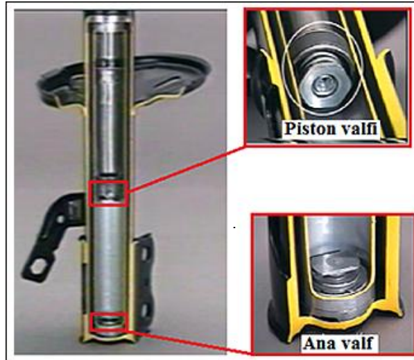
Resim 1.4: Çok tesirli çift borulu hidrolik amortisörün valfleri
