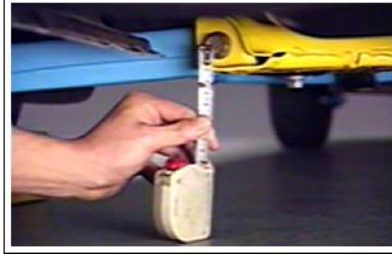
Resim 2.6: Araç yüksekliğinin ölçülmesi
