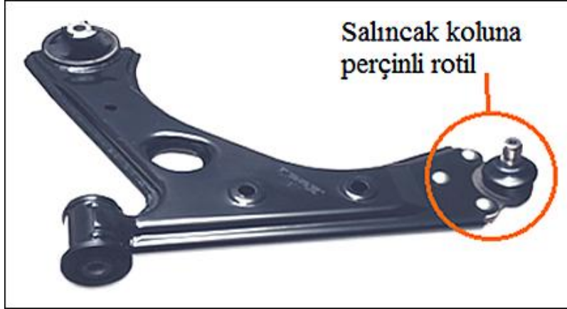
Resim 3.5: Salıncak koluna perçinle sökülemez olarak bağlı rotil
