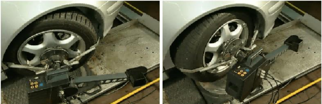
Resim 8.4: Ön düzen cihazının başlıklarının tekerleklere takılması
