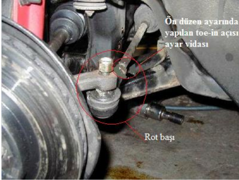
Resim 3.4: Rot başı bağlantı resmi
