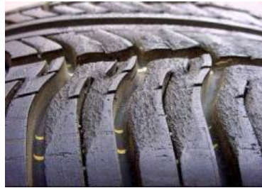
Resim 1.13: Panik fren sonucu, tekerleğin bloke olması ve frenlemenin tek bir bölgede gerçekleşmesi
