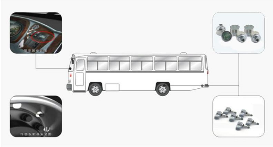
Şekil 2.8: Lastik basınç sensörü araçta takılmış hâlde
