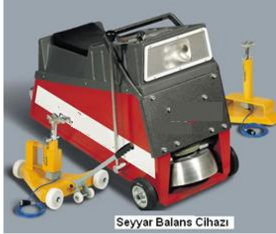
Resim 1.19: Seyyar balans cihazı
