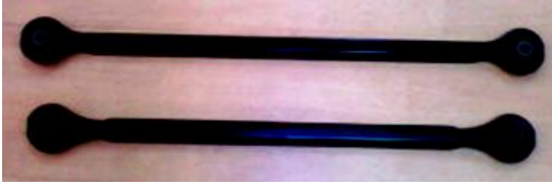
Resim 7.2: Z-rot denge çubuğu
