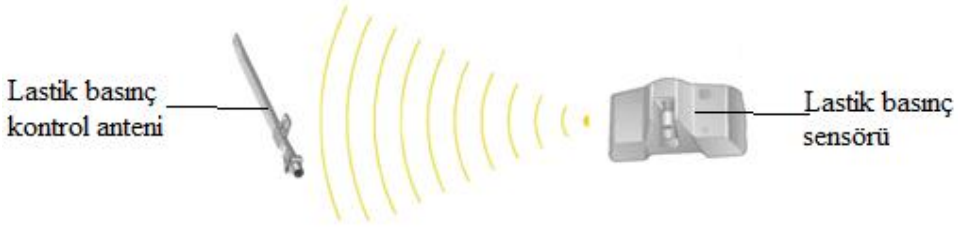
Şekil 2.4: Lastik basınç sensörü verici anteni ve sensör
