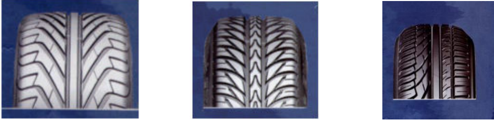
Şekil 1.14: Çeşitli lastik sırtı ve su kanalı profilleri
