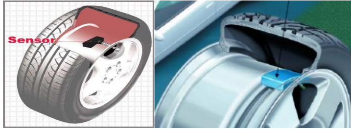
Şekil 2.9: Lastik basınç sensörünün tekerlek üzerindeki yeri
