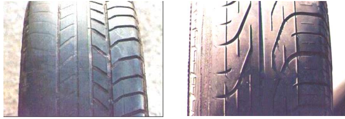
Resim 1.12: Tabanda tek omuzda düzensiz aşınma (çevresel)
