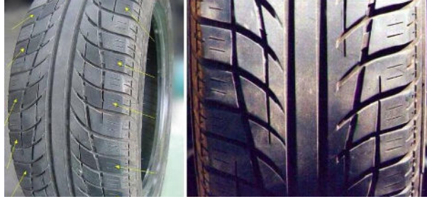
Resim 1.15: Aks yataklarındaki boşluk sonucu oluşan aşınmalar
