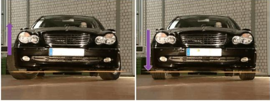
Resim 8.2: King-pim açısı direksiyon toplama etkisi
