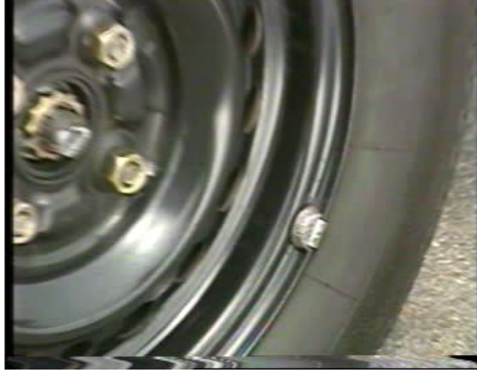
Resim 1.20: Janta akılan balans aęırlıęı
