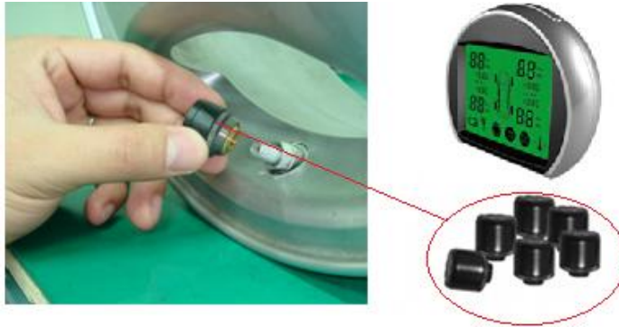
Resim 2.2: Lastik basınç sensörü dıştan uygulama
