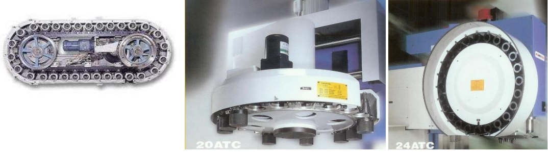
Şekil 1.9: Değişik magazin tipleri
