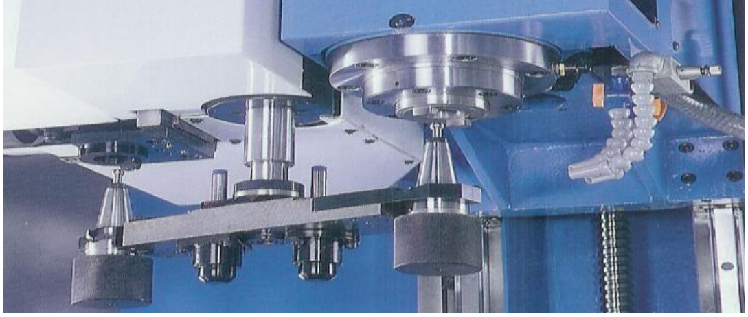
Şekil 3.3: Bir CNC tezgâhında kesici takımın otomatik değıştirilmesi
