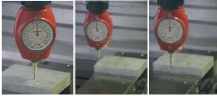
Resim 1.2: Referans noktasının prob ile tanıtılması
