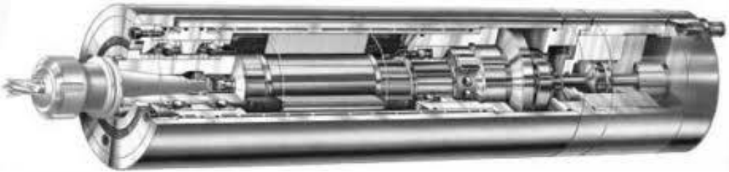
Şekil 1.6: Bir fener mili kesit resmi
